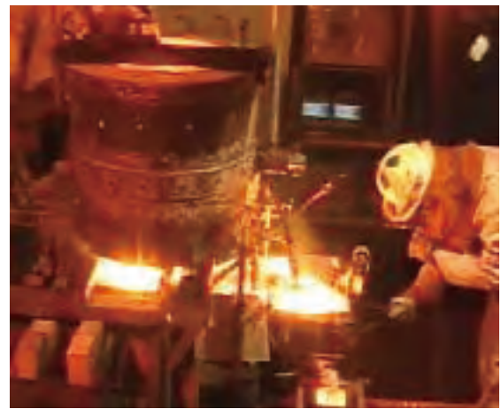
小型連続鋳造機を用いた溶鋼の鋳造実験
